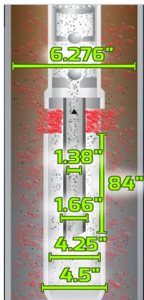
Figura 4.2 Dimensiones del separador de gas Fuente: Gas Separator Simulator Elaborado por: Juan Diego Chicaíza y Ana Tapia
