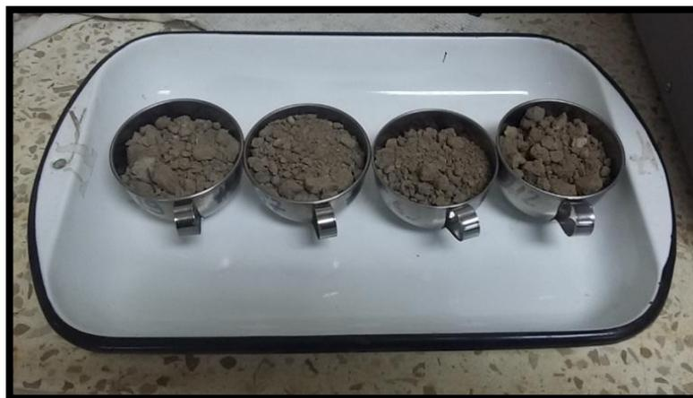
**Figura 32.-** Secado de las Muestras en horno
