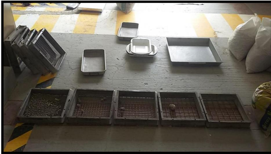
**Figura 25.-** Tamizado de las muestras en las 2 Calicatas.
