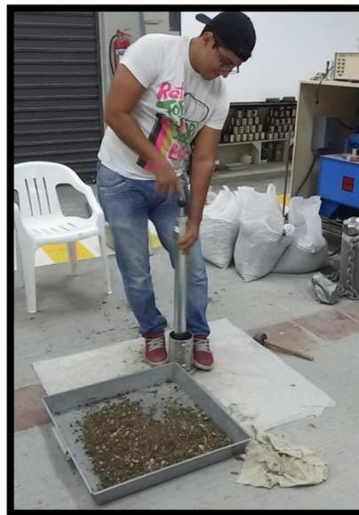
**Figura 30.-** Ensayo de Compactación
