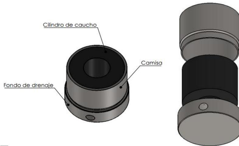
Figura 3. 1 Partes del Porta Núcleo
