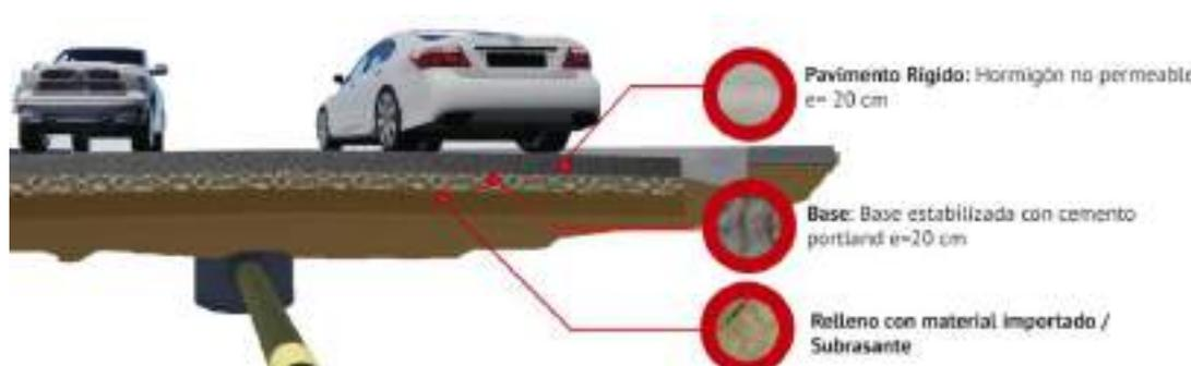
**Figura 4.1:** Sección de vía de pavimento permeable.
