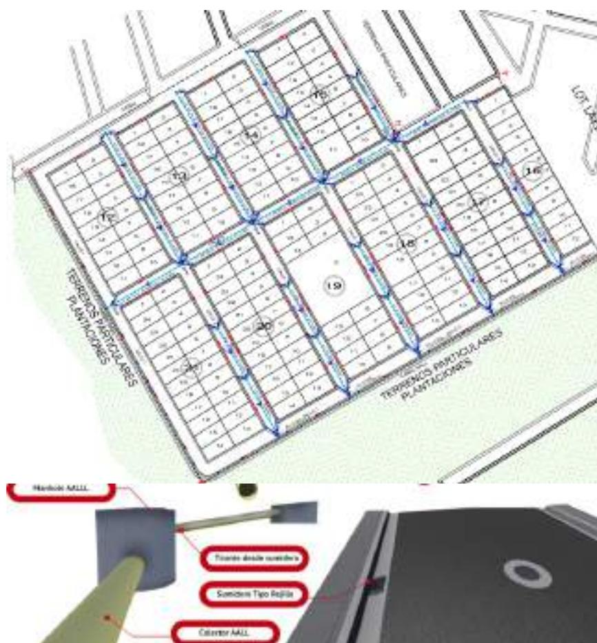
**Figura 4.3:** Sistema de evacuación de AALL alternativa 1.- Sistema tradicional.
