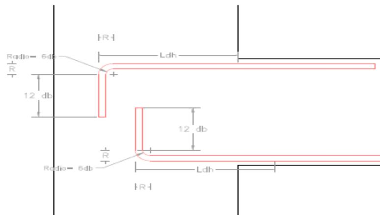
**Figura 4.25:** Dimensiones de las varillas en la zona de anclaje.
