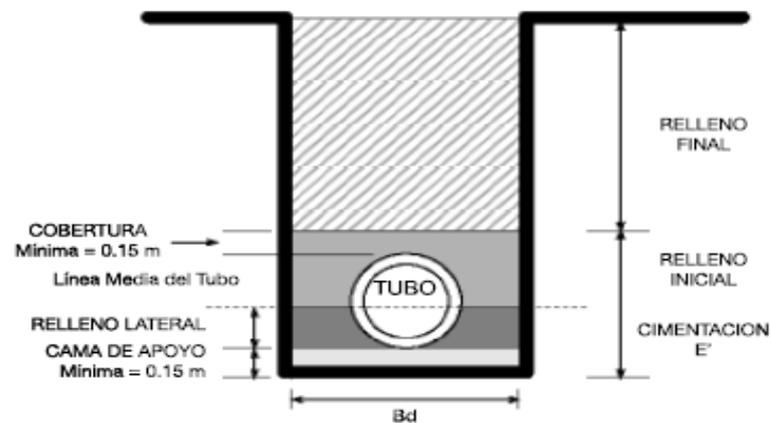
**Figura 4.61:** Cimentación de tubería para cajas de registro.
