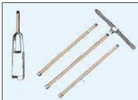
Figura 2.25. Barrena Hueca. Fuente: Braja M. Das
