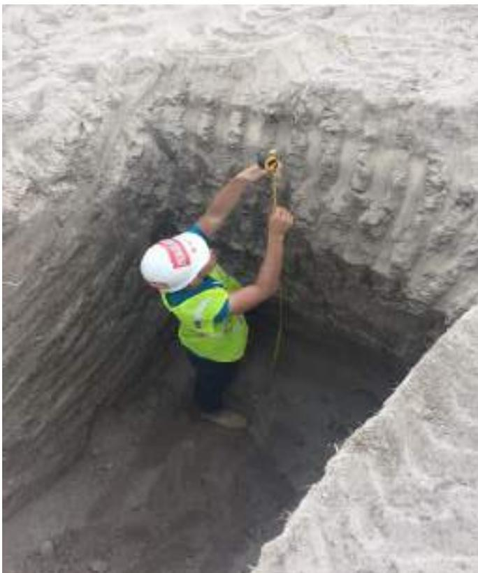
**Figura 3.7** Toma de mediciones y muestras en calicata.
