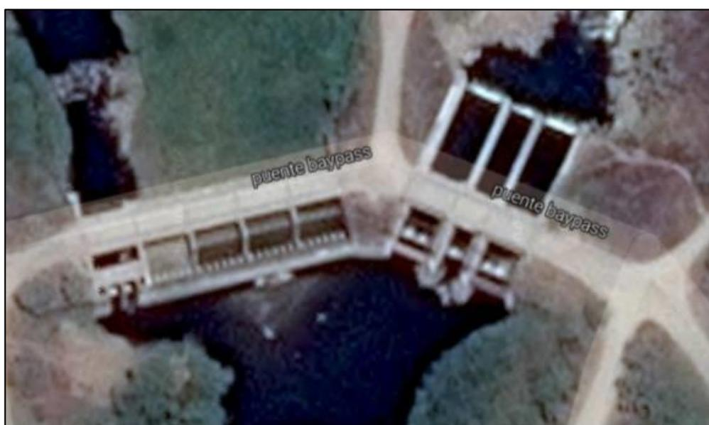
**Figura 2.3:** Presa compuesta por aliviadero y con compuertas rectangulares.
