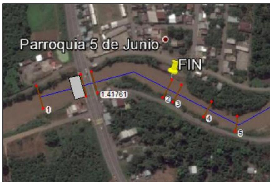
**Figura 2.13:** Secciones aguas abajo vista desde imagen de Google Satellite.
