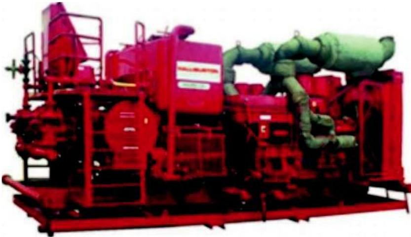
*Figura 2. 19:* Bombas de descarga
