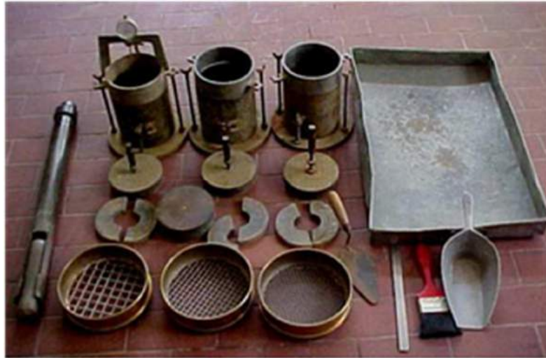
Ilustración 4.3. Material empleado para el ensayo de CBR
