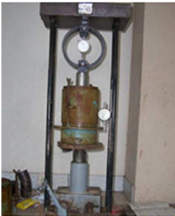
Ilustración 4.4. Aparato medidor de expansión
