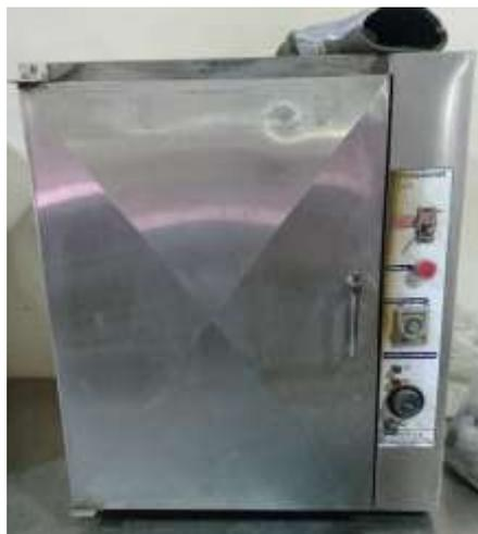
**Figura 2.13** Horno de secado de muestras.
