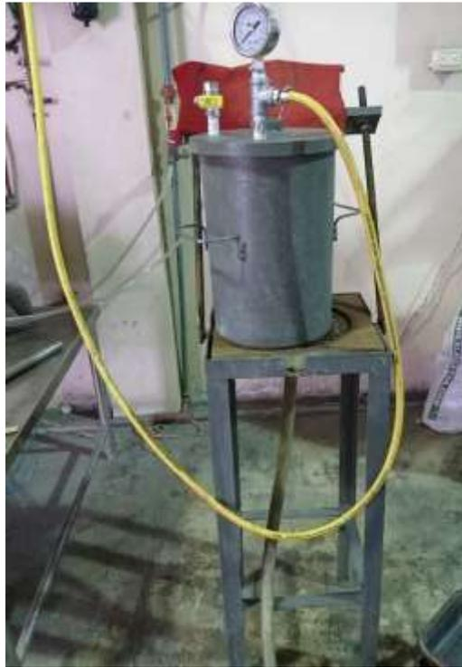
**Figura 2.17** Equipo de filtrado a presión de muestras.
