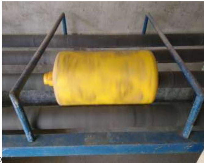
**Figura 2.10** Botella de cianuración de 2 L utilizada en las pruebas de los ensayos.
