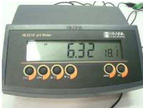
**Figura 2.12** Equipo para realizar medidas potenciométricas de pH.
