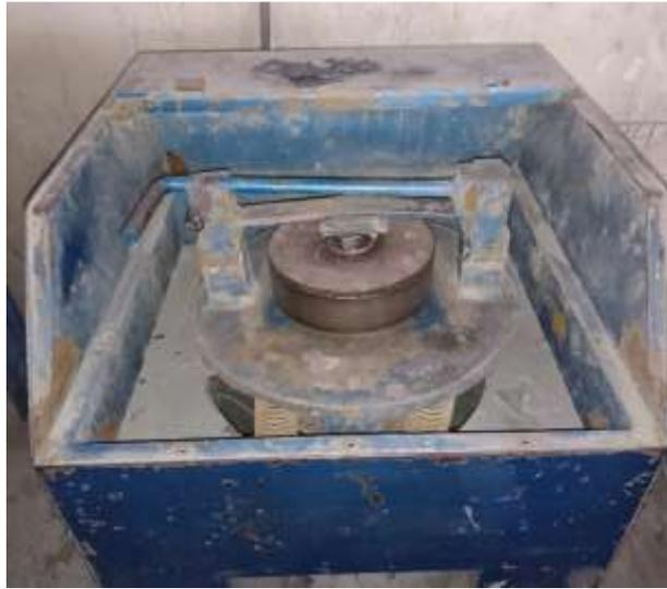
**Figura 2.3** Pulverizador planetario marca Fritsch utilizado en la fase de preparación mecánica.
