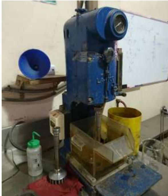
**Figura 2.9:** Celda de flotación Agitair LA-500 utilizada en las pruebas de flotación.
