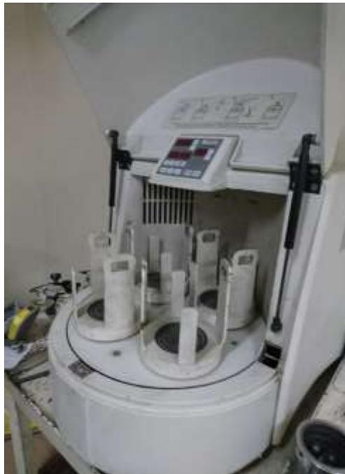
**Figura 2.2** Pulverizador planetario marca Fritsch utilizado en la fase de preparación mecánica.
