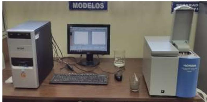
**Figura 2.16** Equipo para determinar la granulometría.
