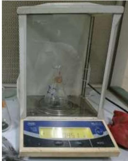
**Figura 2.15** Balanza analítica para pesado.
