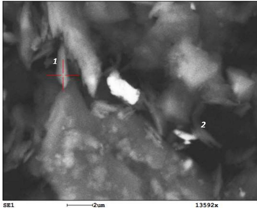
**Figura 3.8** Análisis puntual de materia carbonosa asociada a la mena, observar partículas 1 y 2 con estructura de hojas en la imagen.
