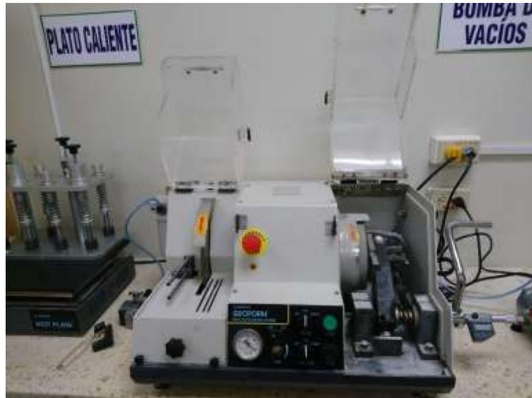
**Figura 2.4** Máquina utilizada para realizar el corte y desbaste de láminas.
