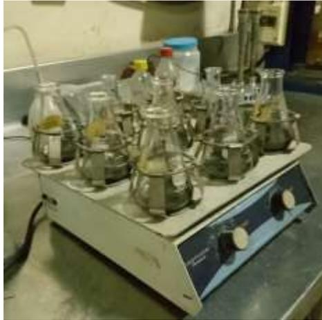
**Figura 2.14** Agitador orbital para pruebas preg-robbing.
