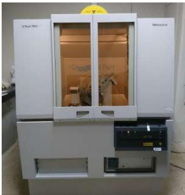
**Figura 2.7** Equipo utilizado para análisis de difracción de rayos X.
