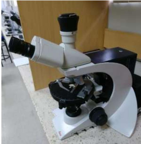
**Figura 2.5:** Microscopio utilizado para análisis de láminas delgadas.
