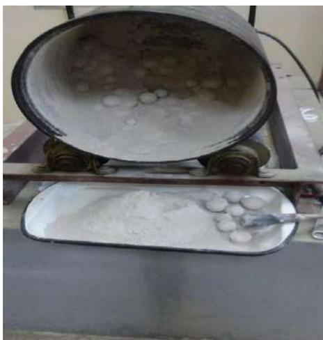
**Figura 3. 6** Extracción del material de la molienda
