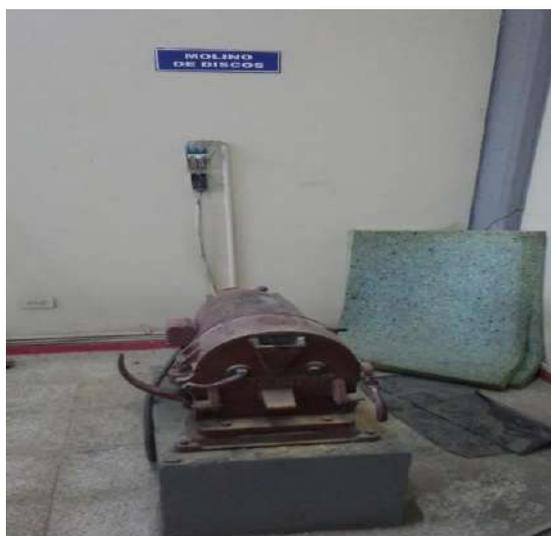
**Figura 3. 4** Molino de disco usado para la trituración fina del material
