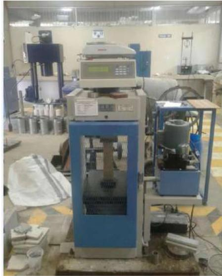
**Figura 2. 1** Maquina de ensayo para resistencia a compresión
