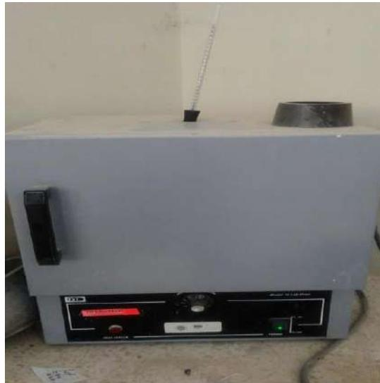
**Figura 3. 9** Horno a una temperatura de 90°C para el curado de la mezcla
