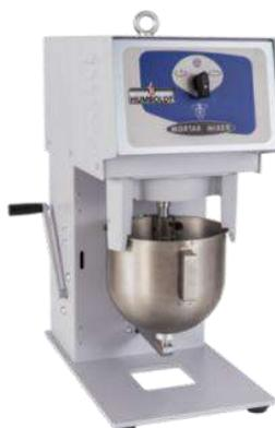
**Figura 3. 8** Tazón mezclador para la elaboración de especímenes
