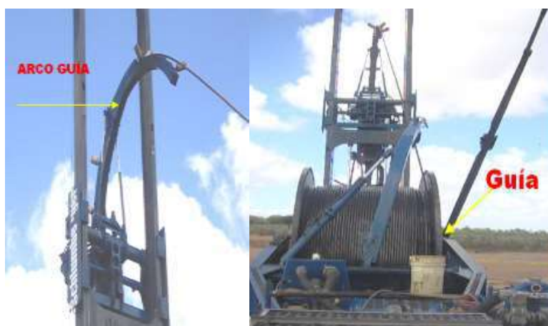
Figura 2.5 Arco y guía nivelador del CTU
