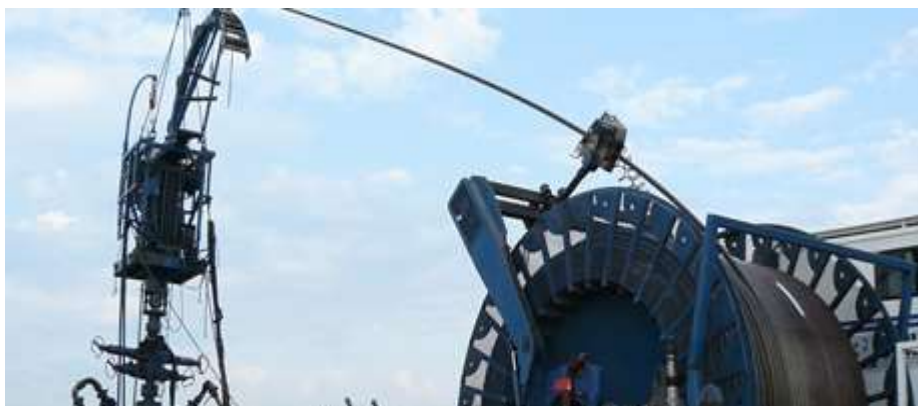
Figura 2.1 Tubería flexible CT
