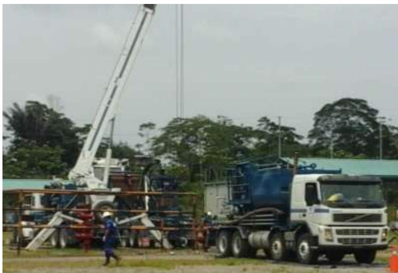
Figura 2.2 Unidad de tubería flexible
