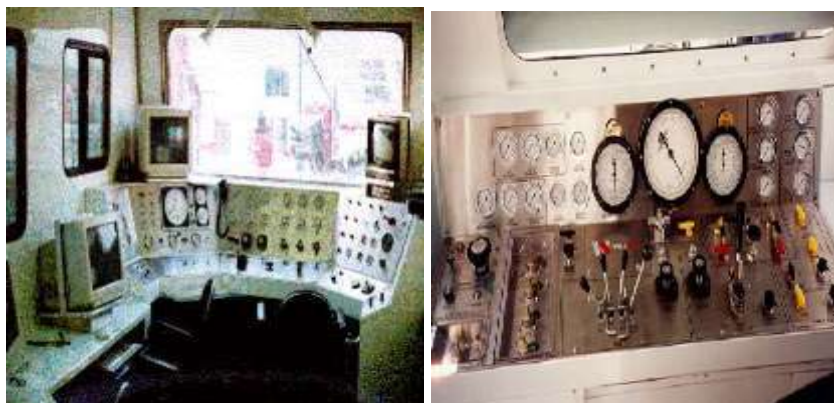
Figura 2.10 Cabina de control del CTU
