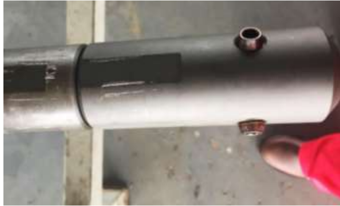
Figura 2.14 Herramienta hydra blast pro
