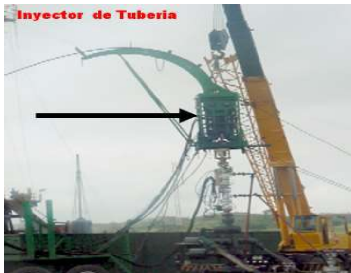
Figura 2.4 Inyector de tubería del CTU
