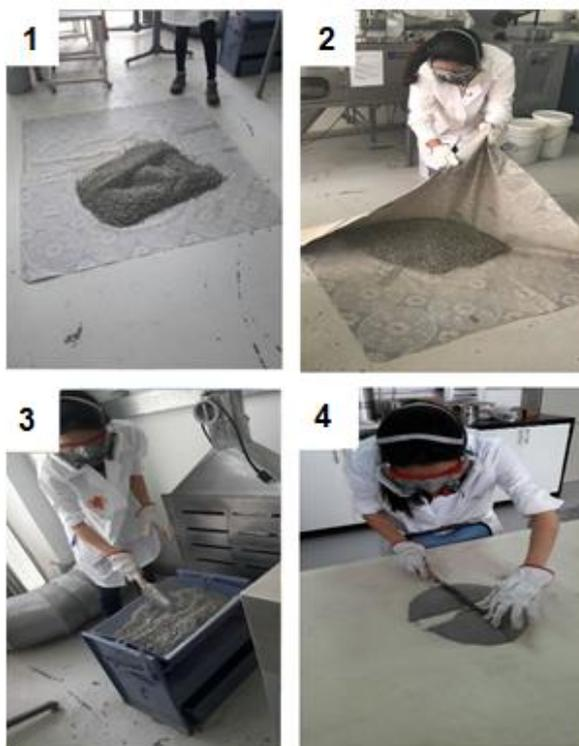
**Figura 3.3** Homogenización y cuarteo del mineral de cabeza
