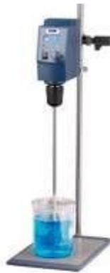
**Figura G.7** Agitador mecánico Dragon Lab OS20 Pro
