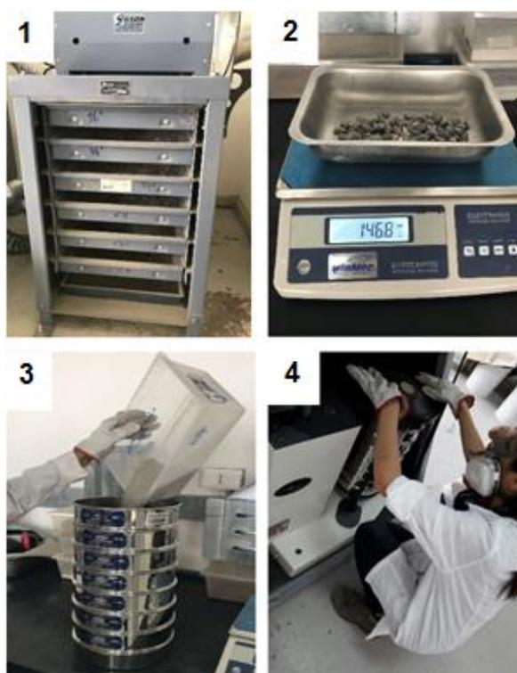
**Figura 3.4** Análisis granulométrico del mineral de cabeza
