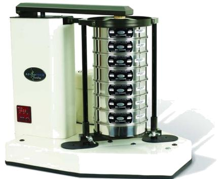
**Figura G.4** Dura Tap Advantech DT 258 y tamices Gilson de 8"
