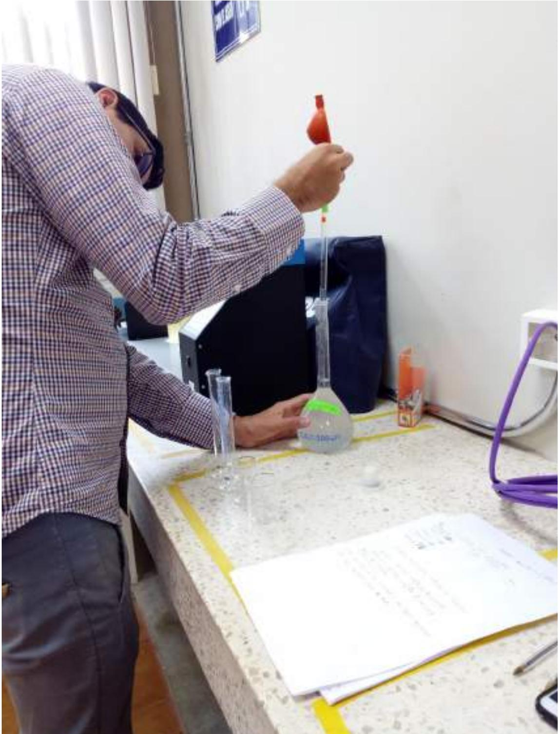
**Figura B-10.** Vertido del floculante.
