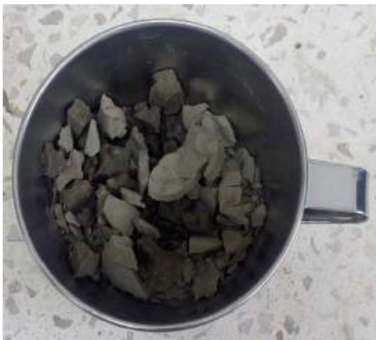
**Figura 3.2** Lodo seco antes de pulverizar.
