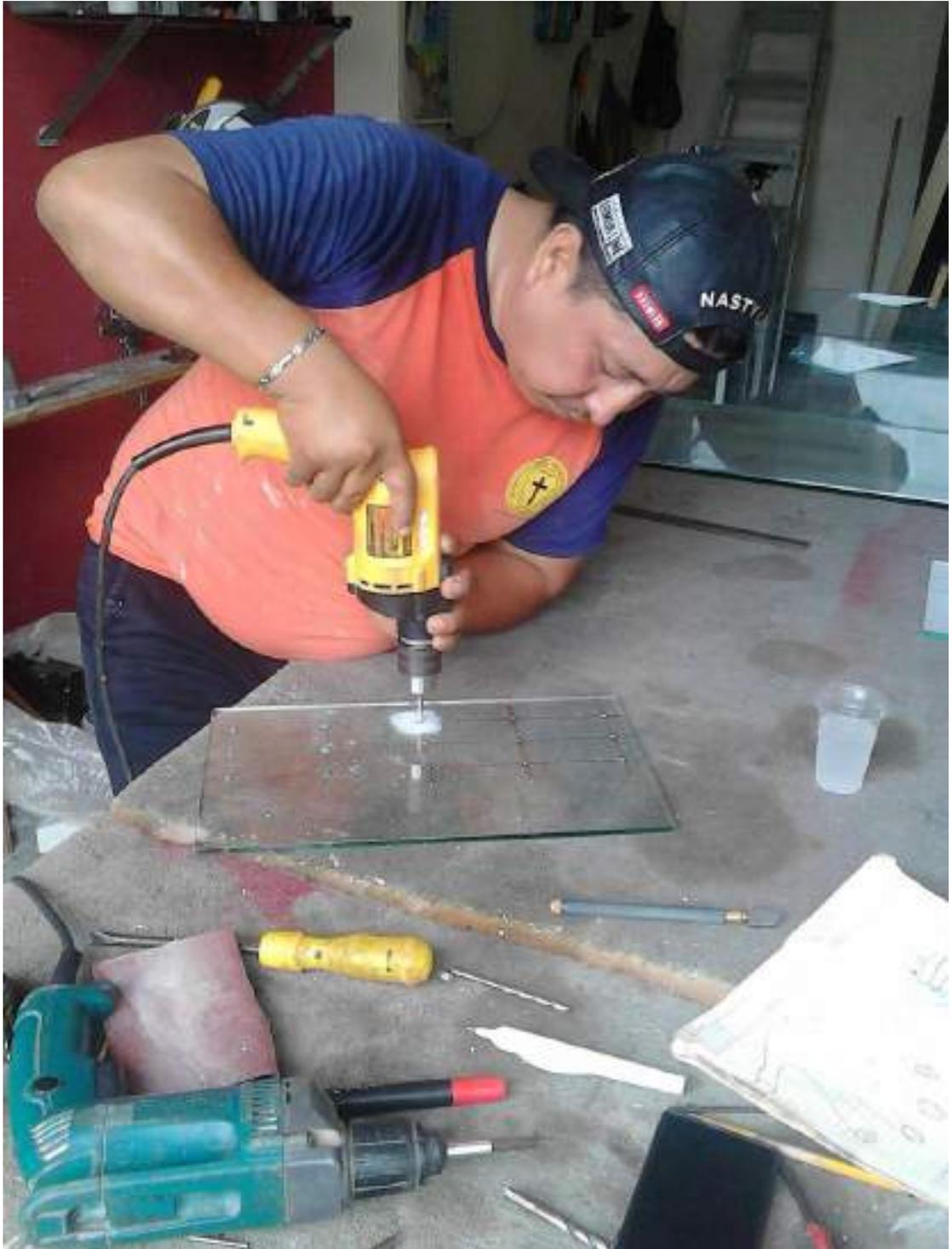
**Figura D-6.** Pantalla difusora con agujeros requeridos por el diseño.
