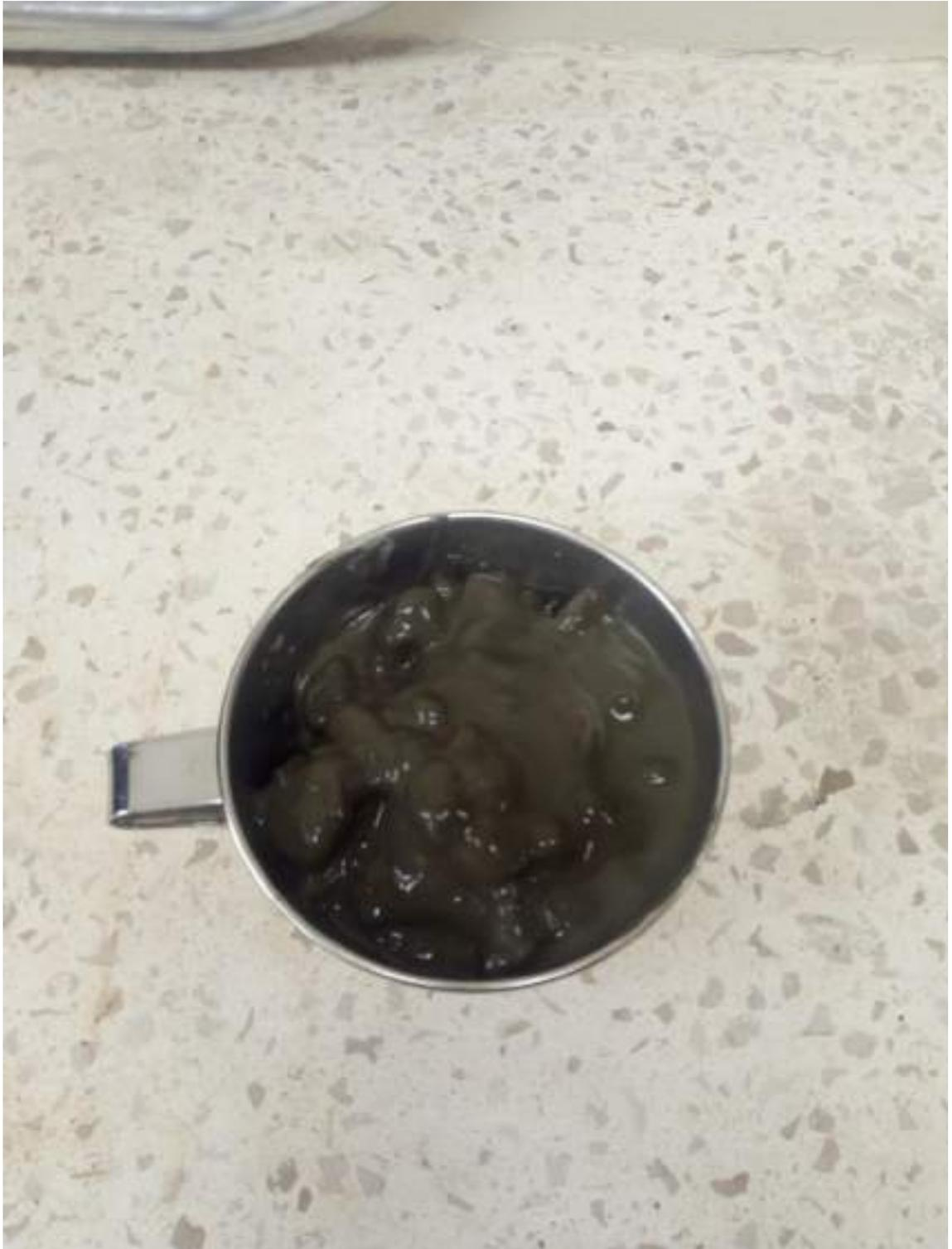
**Figura B-14.** Lodo seco listo para pulverizarlo.
