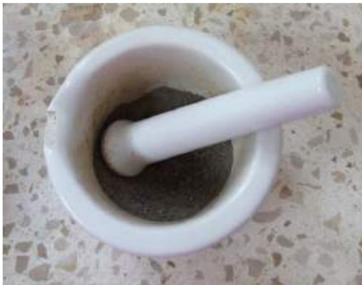
**Figura 1.3** Mortero con lodo pulverizado.
