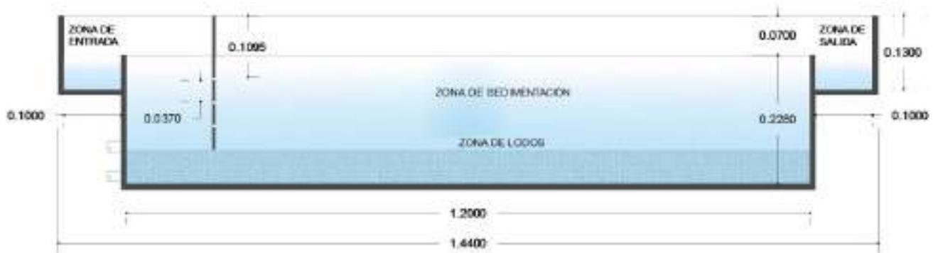
**Figura C-3.** Pantalla difusora con orificios.
