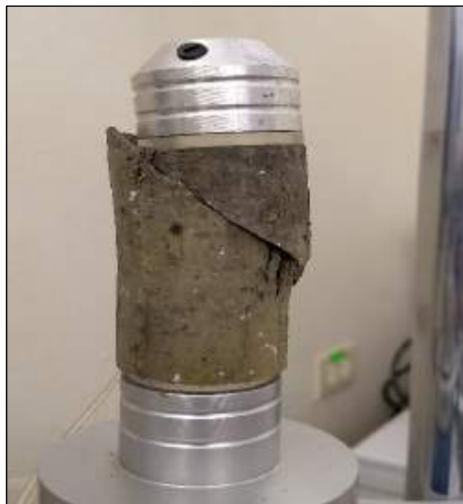
Figura 5.18 Núcleo ensayado de muestra A Fuente: Rodríguez, O., Condoy, A., 2017.
