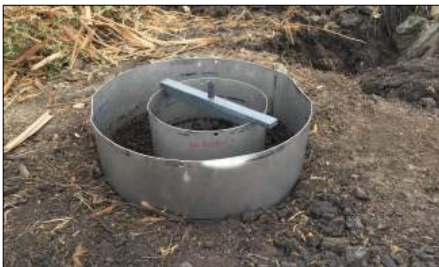
Figura 5.13 Ensayo de permeabilidad in situ
