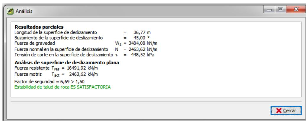
**Figura 0.10** Resultado del análisis de talud 2
