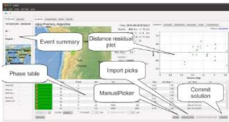
**Figura 3.6** Ventana de Seiscomp3 donde se muestra todos los datos de un evento sísmico, proporcionado por el IGEPN, 2017.
