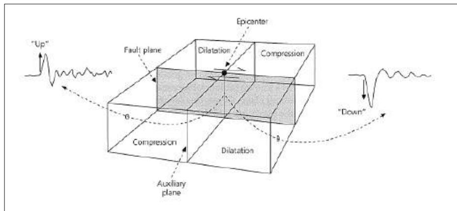
**Figura 3.9** Movimientos de ondas P observados en sismómetros ubicados en varias direcciones alrededor de un evento sísmico.
