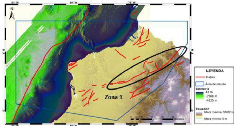
**Figura 2.6** Sistemas de fallas activas en el segmento norte del Ecuador. Las fallas son una compilación de Alvarado 2013. Zona 1: Sistema de fallas Río Lachas-Canandé. Batimetría IRD (Michaud et al., 2006) remuestrada a 30 m.
