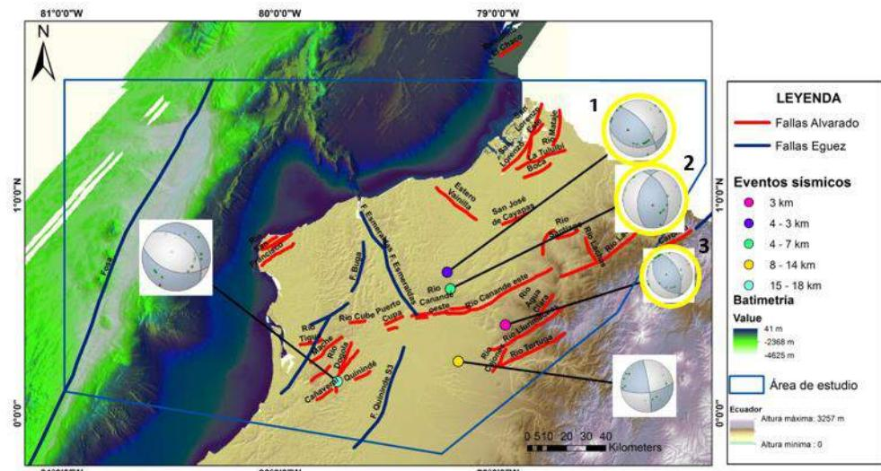
**Figura 4.11** Eventos sísmicos según su profundidad con mecanismos focales en el área de estudio. Los círculos amarillos corresponden a los descritos por Manchuel et al., 2011. Batimetria IRD (Michaud et al., 2006) remuestreada a 30 m.
