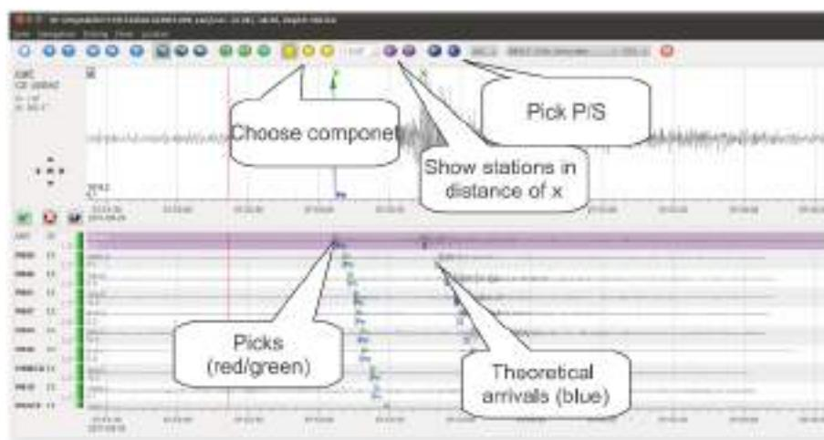
**Figura 3.7** Partes del programa Seiscomp3 para picar en cada una de las estaciones la llegada de la onda P y S.
