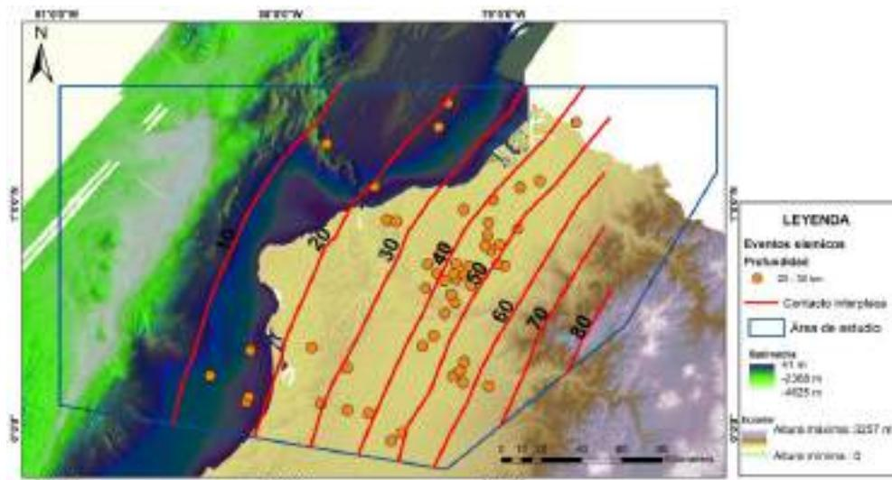
**Figura 5.4** 53 eventos sísmicos relocalizados de profundidad de 20 a 30 km. Las líneas rojas representan el contacto interplaca, descritas por Font et al., 2013. Batimetría IRD (Michaud et al., 2006) remuestrada a 30 m.
