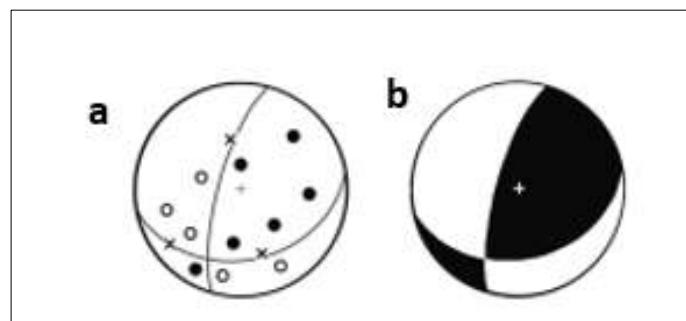
**Figura 3.11** a. Representación estereográfica de datos sísmicos. Todos los círculos representan estaciones con el arribo de la onda P, donde los círculos negros representan compresión (+) y los círculos vacíos dilatación (-). B. Identificación de los cuadrantes.
