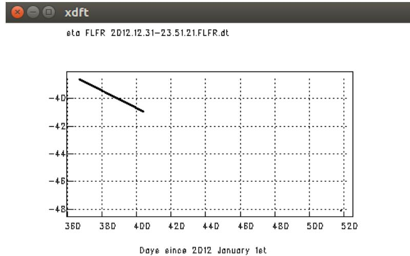
**Figura 3.5** Vista de un ejemplo de un archivo .dt de la estación FLFR en xdf1\_0.EXE, del cual debe ser corregida debido a la ausencia de datos de tiempo, según la pendiente mostrada.
