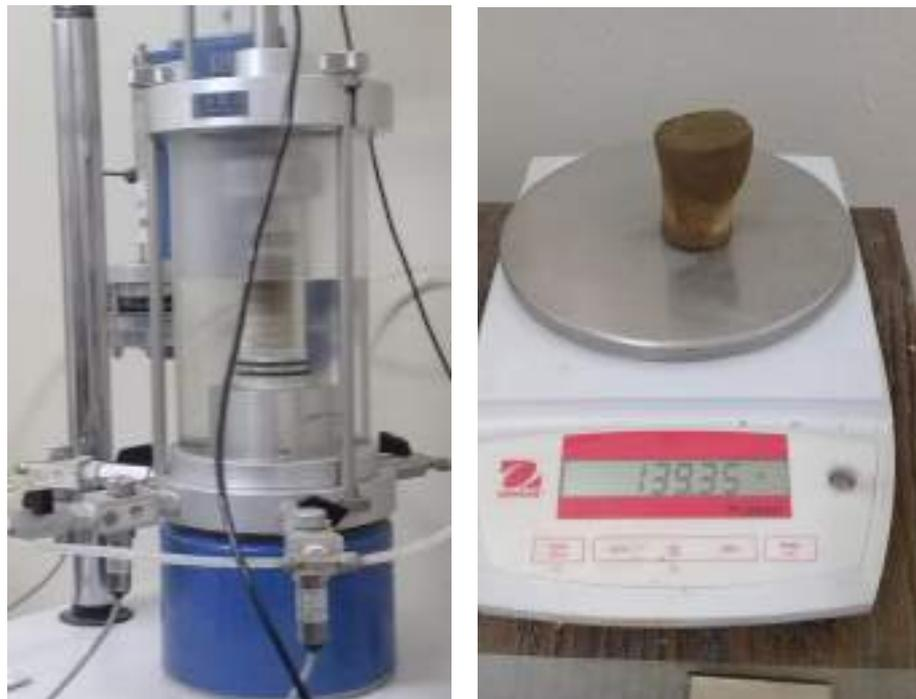
**Figura 2. 11** Probeta cilíndrica en cámara de confinamiento.
