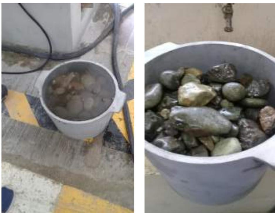
**Figura 2. 13** Proceso de saturación de la muestra.
