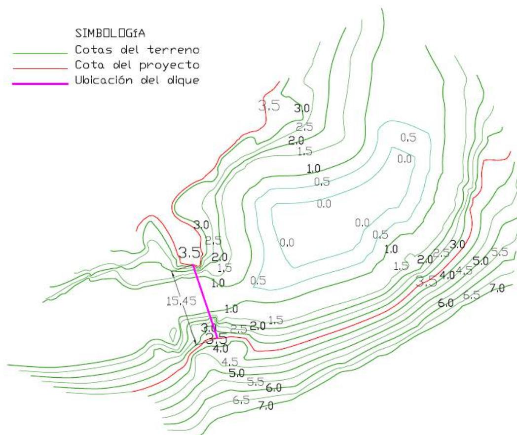
**Figura 4. 1** Plano topográfico con curvas de nivel. Cotas relativas a la parte más baja del cauce del río.
