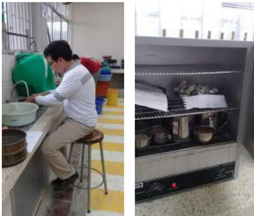
**Figura 3. 39** Lavado de muestras. Puesta a secar en horno.
