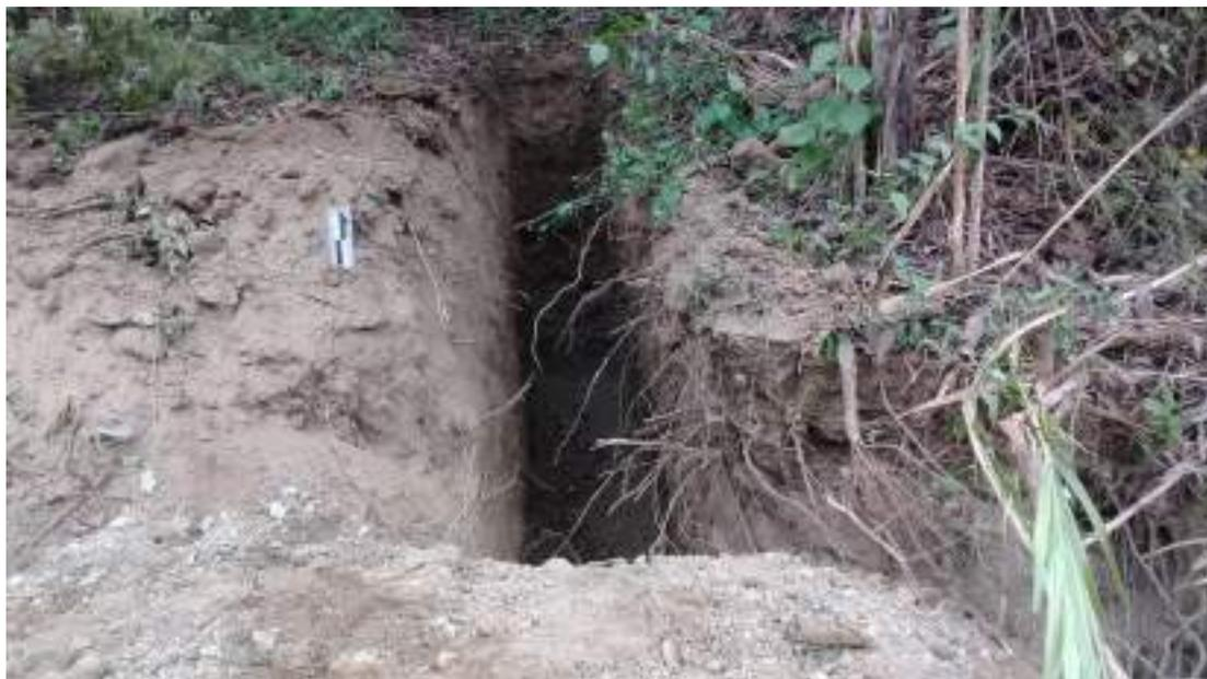
**Figura 3. 16** Calicata hecha con retroexcavadora.
