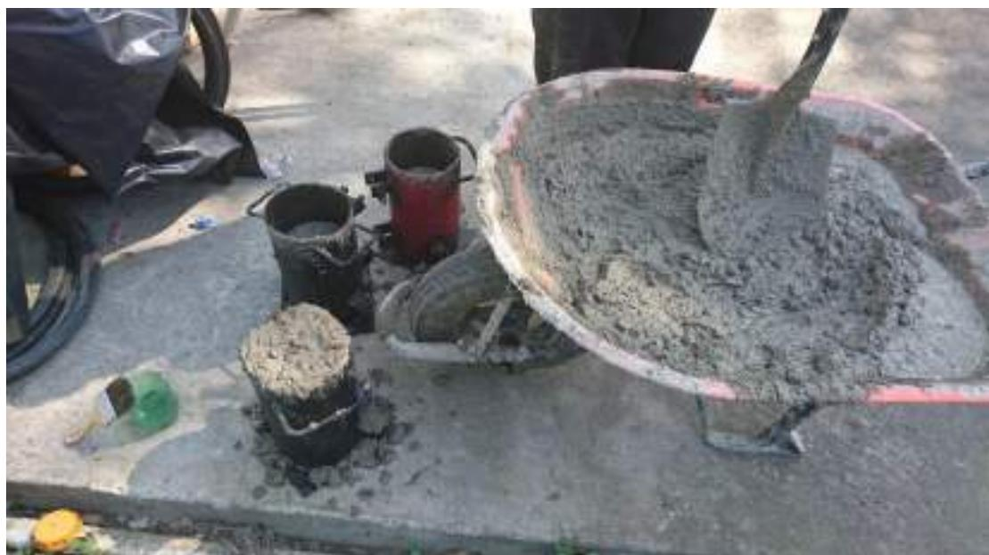
**Figura 3. 44** Elaboración de probetas.
