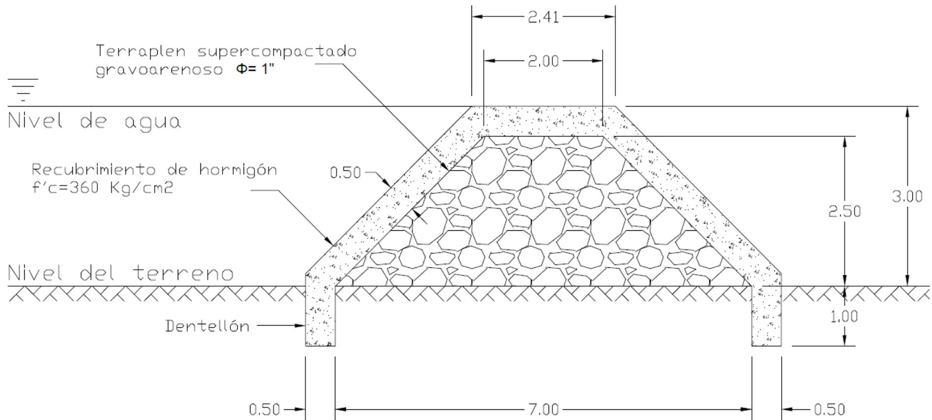
**Figura 4. 5** Sección típica del dique. Corte 1-1'.
