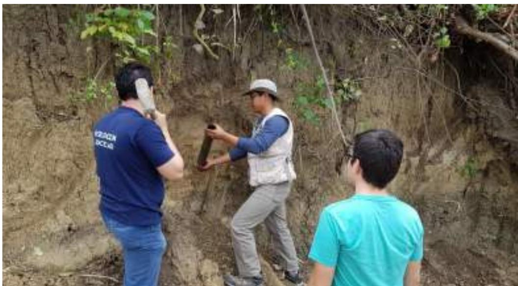
**Figura 3. 18** Hincada de tubo Shelby en talud.
