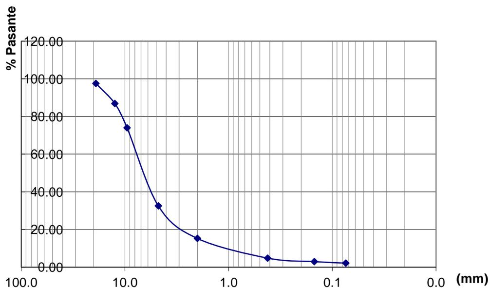
**Figura 3. 26** Curva granulométrica para muestra de talud derecho, P2 en la Tabla III.
