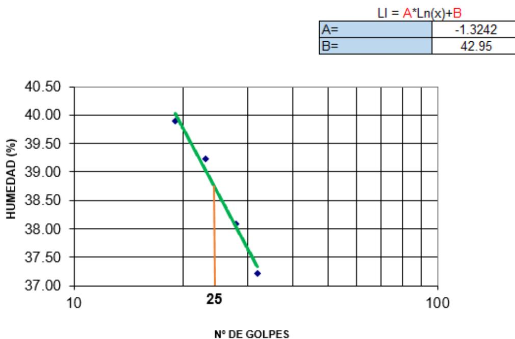
**Figura 3. 29** Límite líquido para muestra de talud izquierdo, P1 en la Tabla III.
