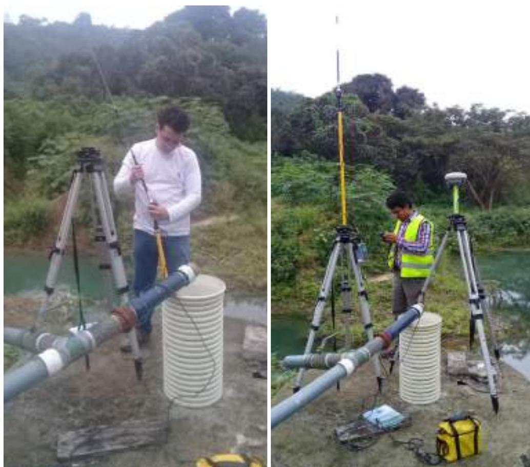
**Figura 3. 4** Ensamblaje de equipo. Base y antena de equipo topográfico, GPS de alta precisión.
