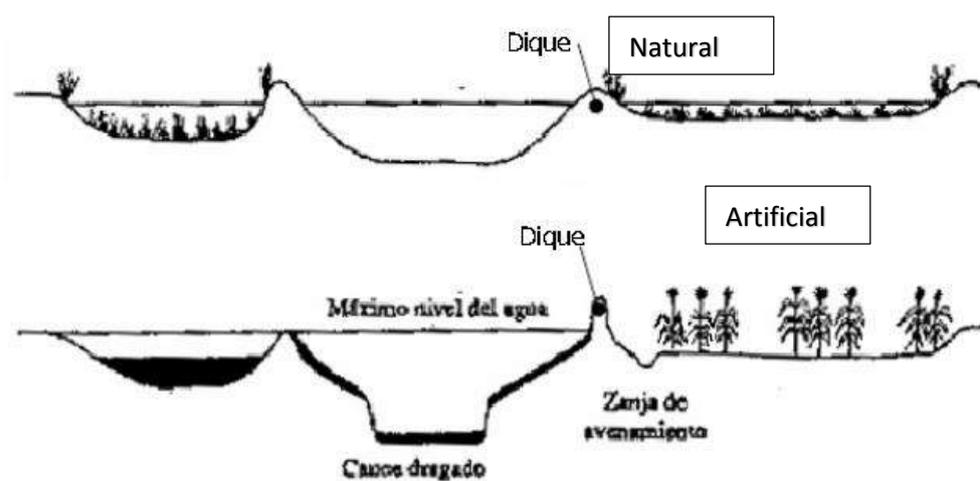
**Figura 2. 7** Comparación dique natural y artificial.
