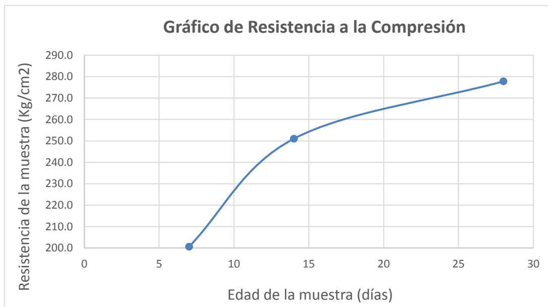
**Figura 3. 45** Gráfico de Resistencia a la compresión Vs. Edad de la probeta.
