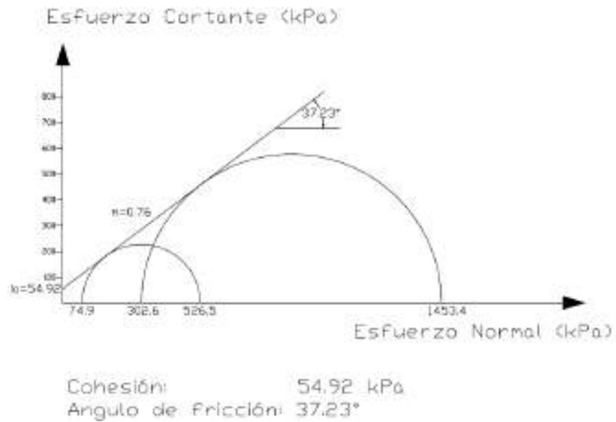
**Figura 3. 33** Círculos de Mohr para muestra de talud izquierdo, P1 en la Tabla III.
