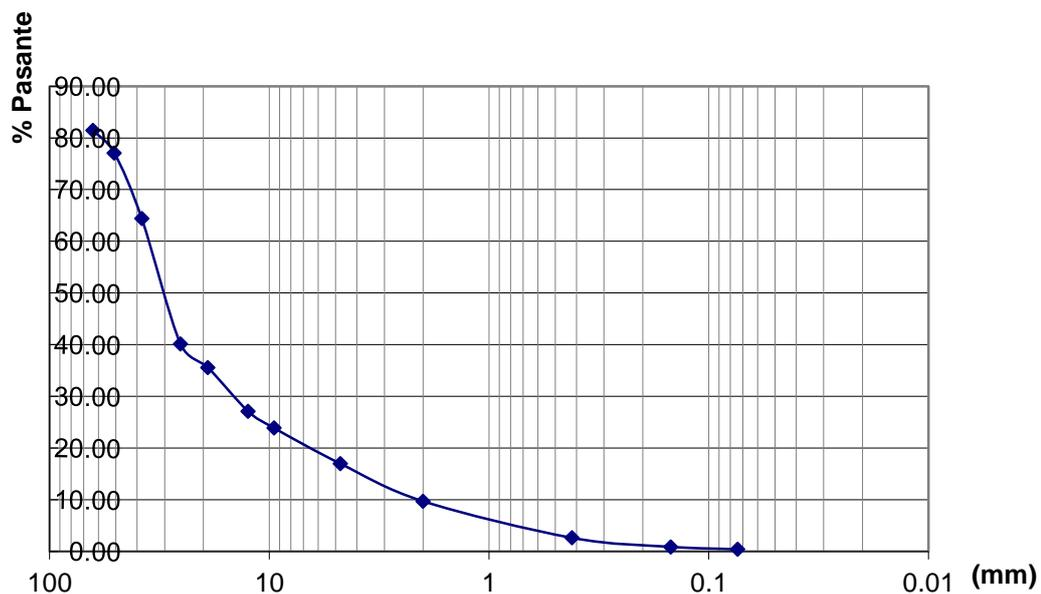
**Figura 3. 27** Curva granulométrica para muestra tomada de la excavación en el río, P3 en la Tabla III.
