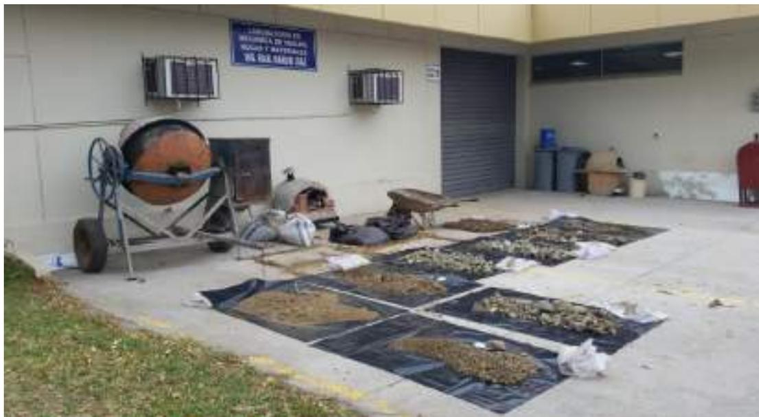
**Figura 3. 23** Muestras de suelos para ensayos secándose.
