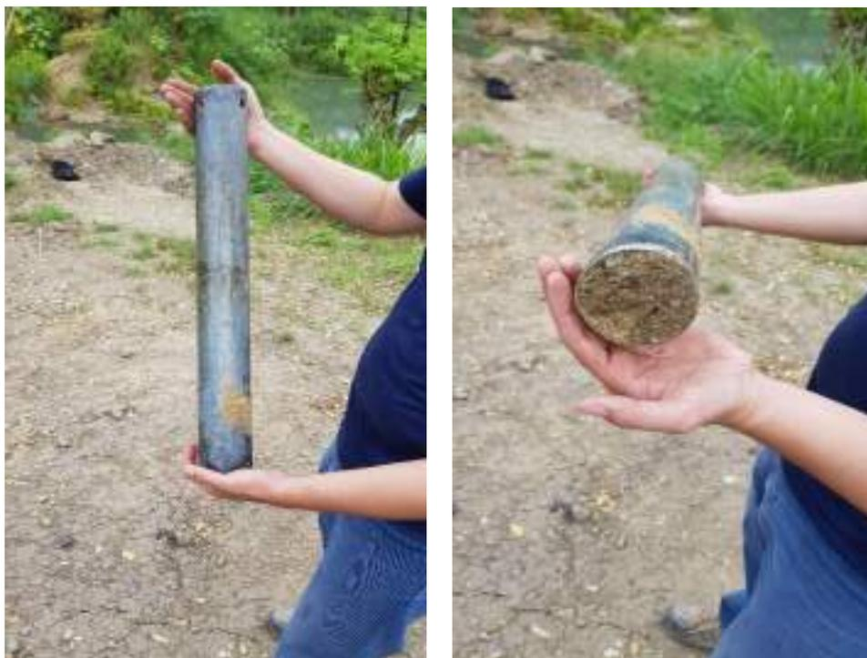
**Figura 3. 19** Muestra extraída del talud.
