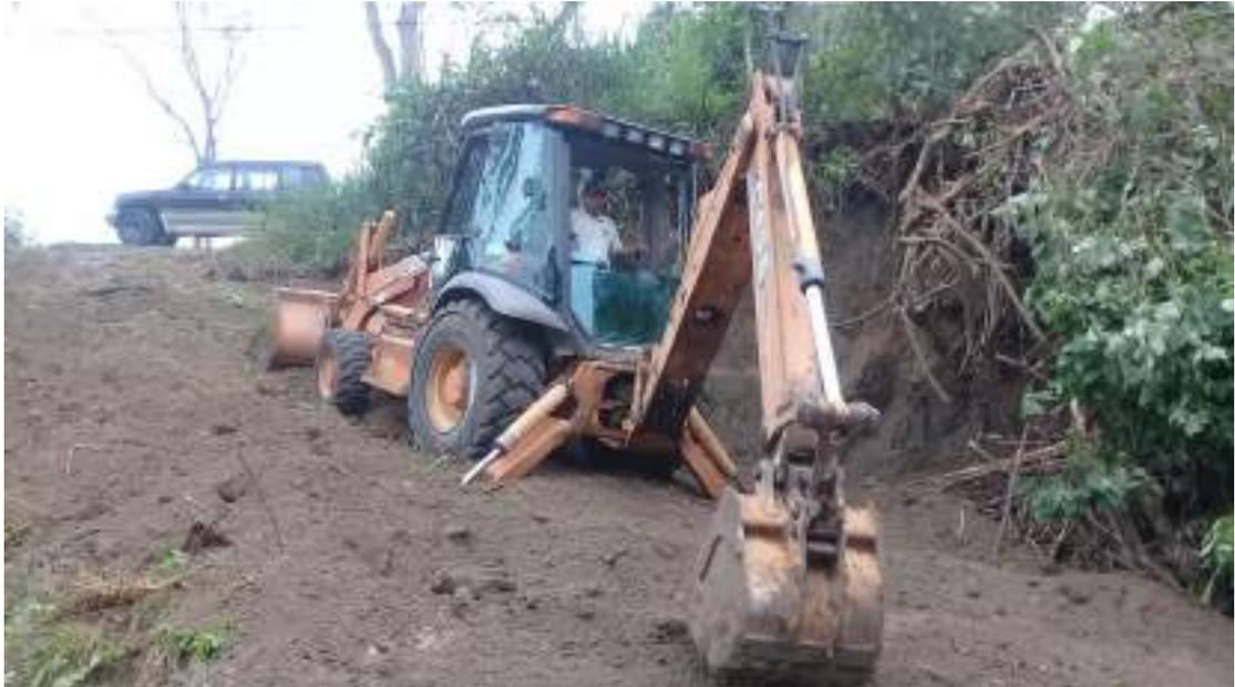
**Figura 3. 20** Retroexcavadora usada para la obtención de muestras.
