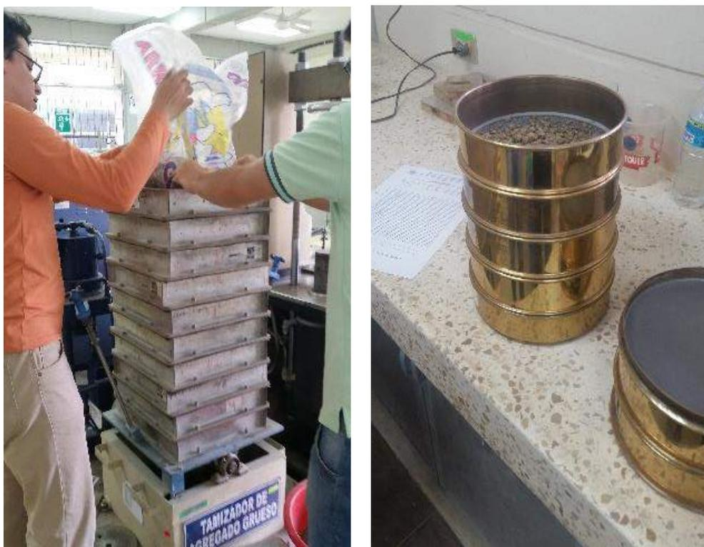
**Figura 2. 9** Granulometría. Tamices Agregado grueso y fino.
