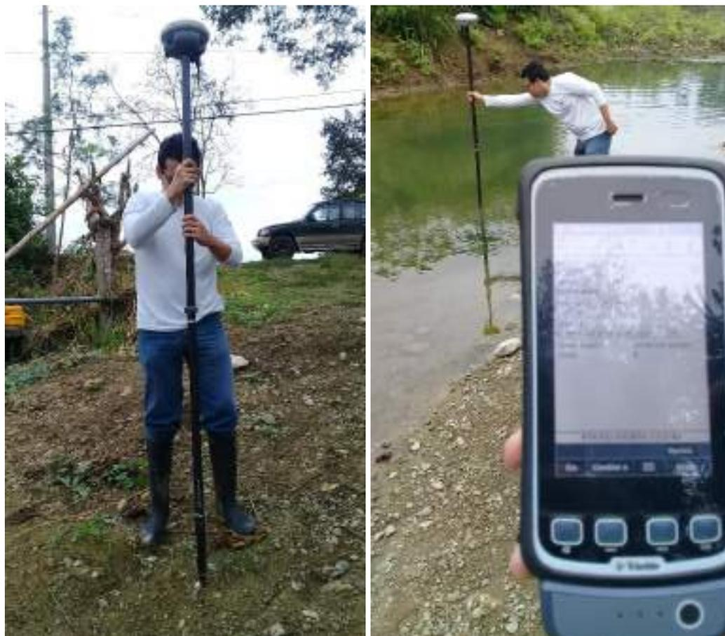
**Figura 3. 5** Receptor y ordenador de mano del GPS.
