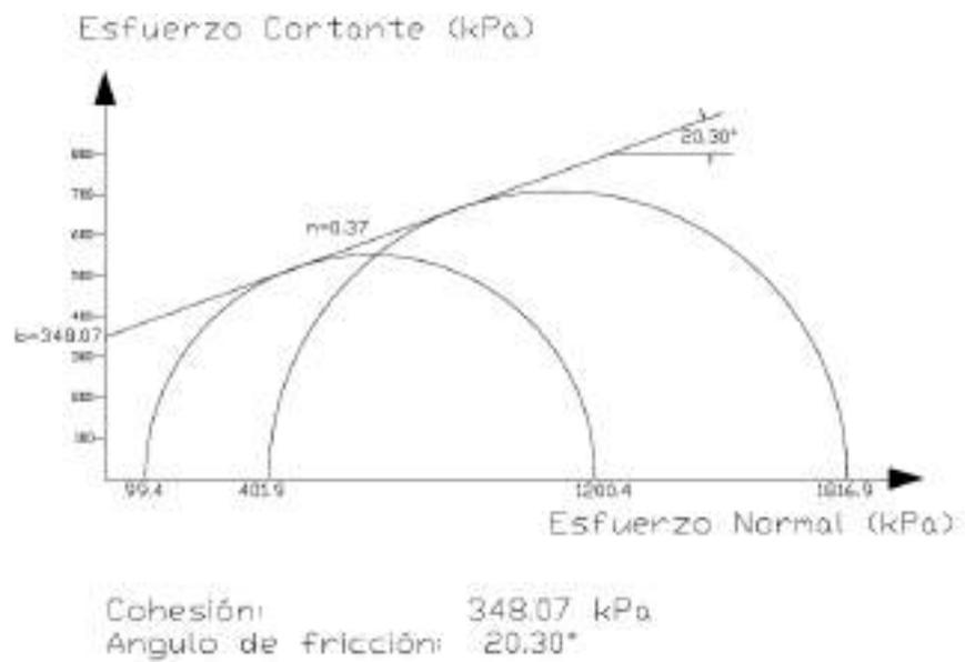
**Figura 3. 34** Círculos de Mohr para muestra de talud derecho, P2 en la Tabla III.
