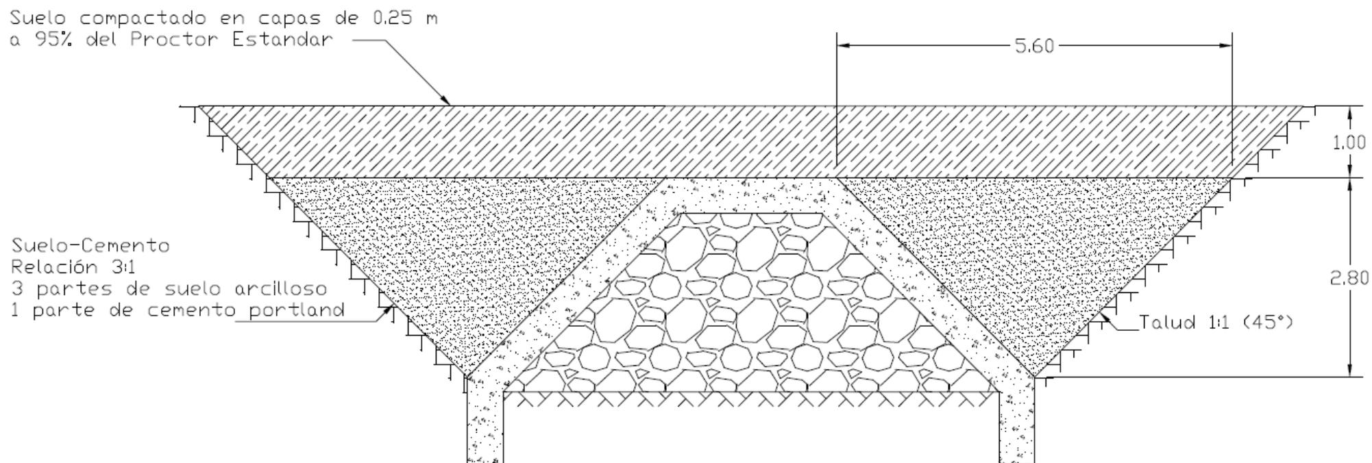
**Figura 4. 6** Sección del dique en los empotramientos. Cortes 2-2' y 3-3'.
