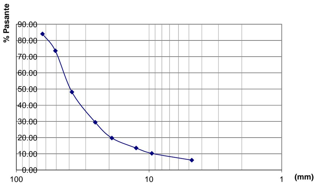
**Figura 3. 28** Curva granulométrica para muestra tomada superficialmente en el centro del río, P4 en la Tabla III.
