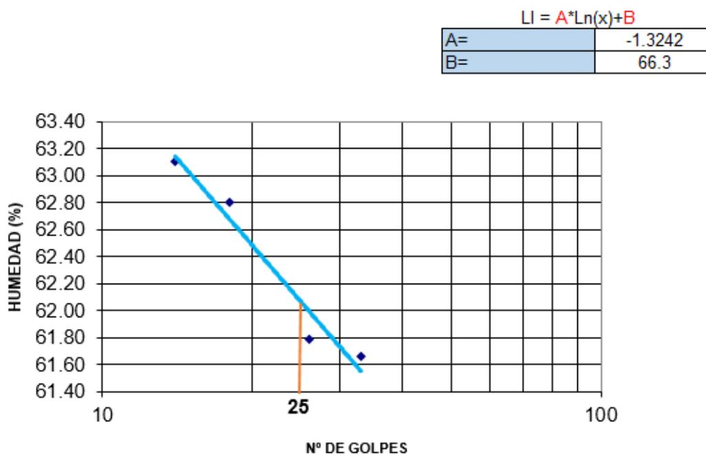
**Figura 3. 30** Límite líquido para muestra de talud derecho, P2 en la Tabla III.
