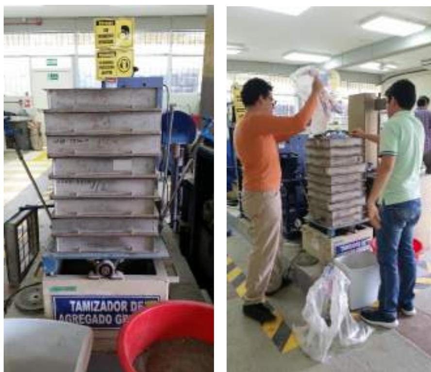
**Figura 3. 24** Tamizado de muestra para análisis granulométrico.
