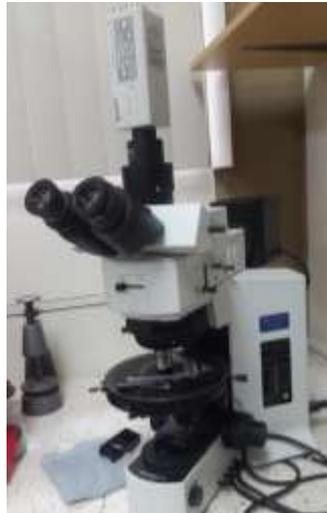
**Figura 2.7:** Microscopio mineragráfico marca Olympus BX51
