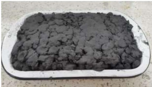
**Figura 2.3:** Concentrado refractario de oro apelmazado antes del secado.
