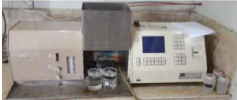
**Figura 2.8:** Equipo de espectrofotometría de absorción atómica Buck Scientific modelo 210 VGP.
