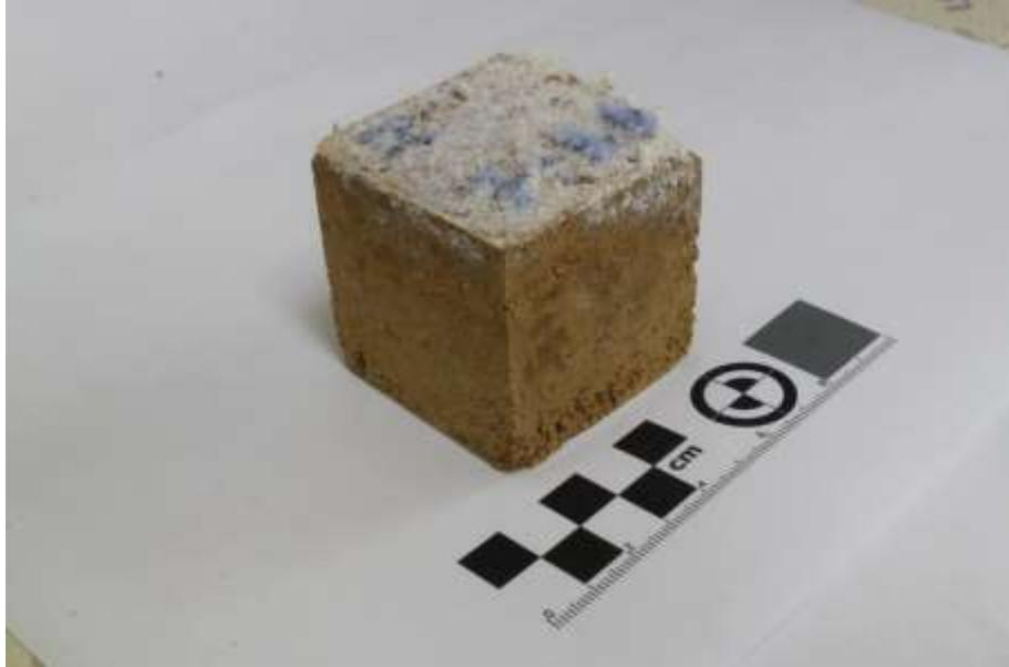
**Figura A-3.** Concreto de geopolímero en cubos de 5 cm de arista. Condiciones: Temperatura de 900 °C, 40 wt% contenido de  $\text{Ca}(\text{OH})_2$ , y tiempo de activación de 75 minutos.
