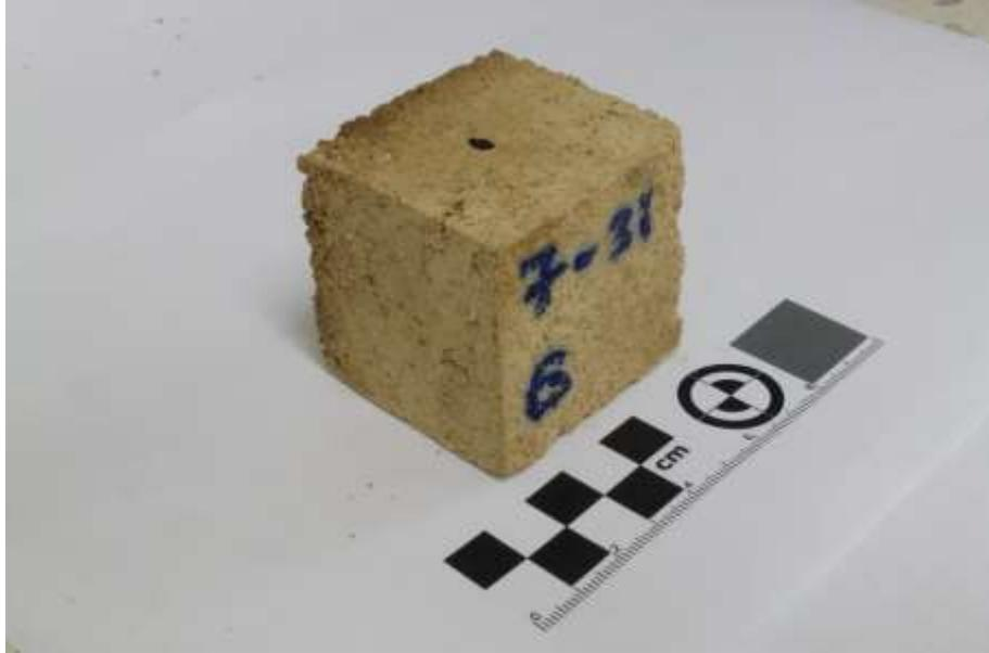
**Figura A-7.** Concreto de geopolímero en cubos de 5 cm de arista. Condiciones: Temperatura de 800 °C, 40 wt% contenido de  $\text{Ca}(\text{OH})_2$ , y tiempo de activación de 120 minutos.
