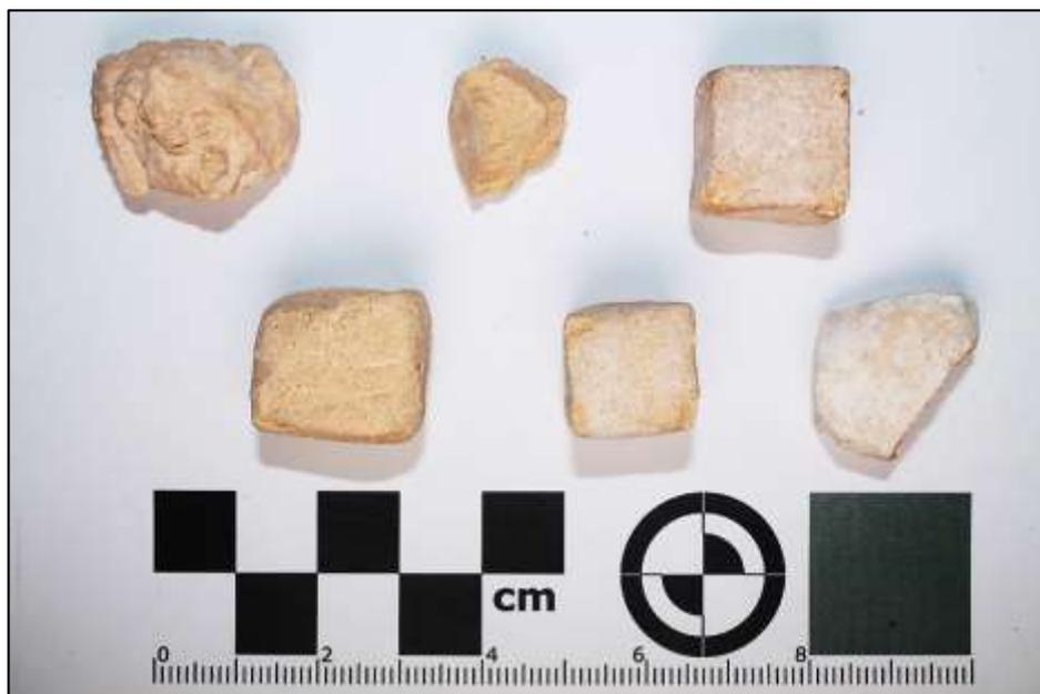
**Figura 2.3** Muestras iniciales de geopolímero en diferentes condiciones exploratorias.
