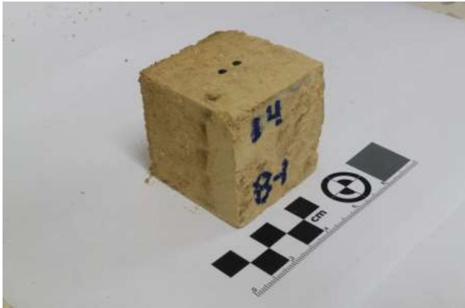
**Figura A-15.** Concreto de geopolímero en cubos de 5 cm de arista. Condiciones: Temperatura de 900 °C, 27.5 wt% contenido de  $\text{Ca}(\text{OH})_2$ , y tiempo de activación de 30 minutos.
