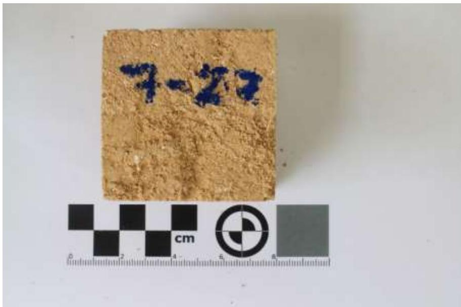
**Figura A-2.** Concreto de geopolímero en cubos de 5 cm de arista. Condiciones: Temperatura de 800 °C, 15 wt% contenido de  $\text{Ca}(\text{OH})_2$ , y tiempo de activación de 30 minutos.
