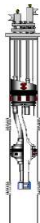
Figura 2.3 Completación Doble para un sistema multi zona.
