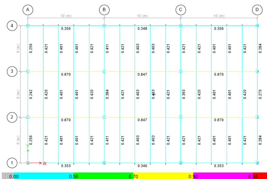
Figura 4.64. Verificación de las secciones vista en planta en el modelo ETABS, alternativa 2 Fuente: Los autores.
