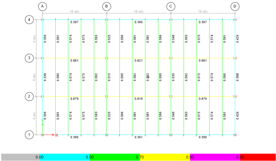
Figura 4.79. Verificación de secciones en el modelo ETABS, alternativa 3. Fuente: Los autores.
