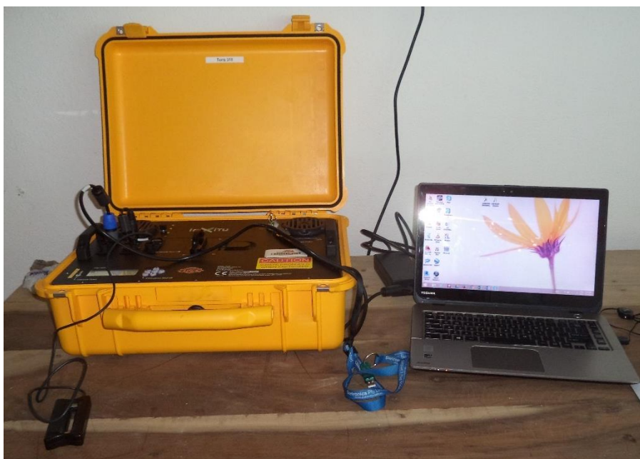
Figura 0.4 Consola difractómetro portátil TERRA de OLYMPUS conectada al ordenador. Fuente: Autor
