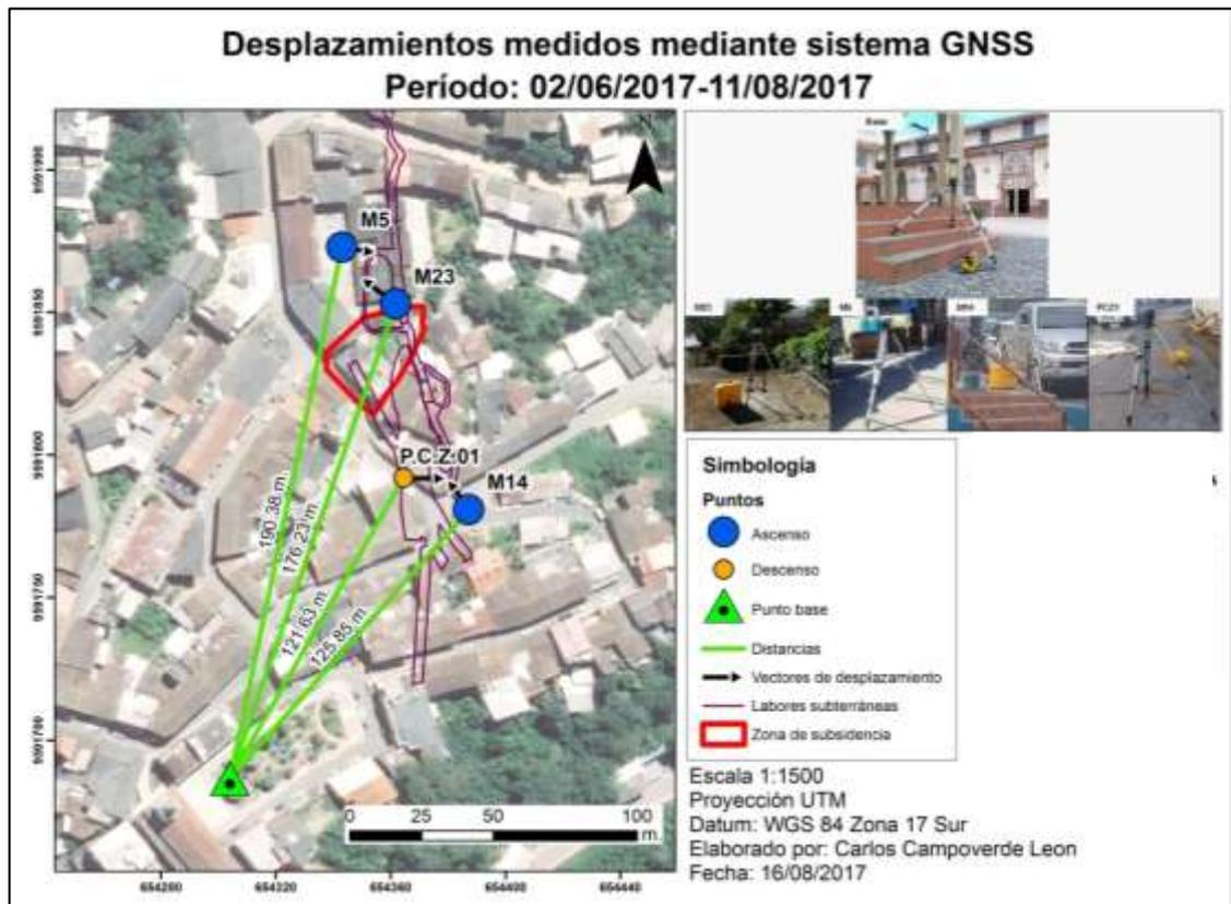
**Figura 4. 6** Mapa de desplazamientos horizontales y verticales en la zona de estudio 1, monitoreo mediante sistema GNSS.
